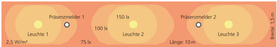
Grundriss eines Korridors mit Leuchten und Isolux-Kurven
